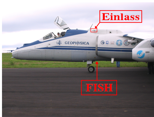
Abbildung 3.2: Das russische Höhenforschungsflugzeug „M-55 Geophysica“ (oben, Bild von Fábio H. Silva dos Santos). Die Positionen von FISH und Einlass sind im nebenstehenden Bild zu sehen (Bild von Dr. Fred Stroh).
