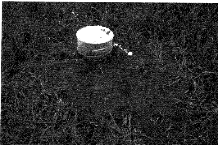
Bild 3: Emissionspunkte von Flözgas führen lokal zu kümmerlichem Wuchs oder zu einem vollständigen Ausbleiben der Vegetation. Abgebildet ist solch ein Emissionspunkt, an dem eine Einschlußkammer aufgebaut ist. Getreideacker an der Straße „Auf dem Schill“, im Westen des Kreises Hamm. Meßwerte sind dargestellt in der Abb. 8.26 und in der Tab. 8.5a (unter „Auf dem Schill 2“).
