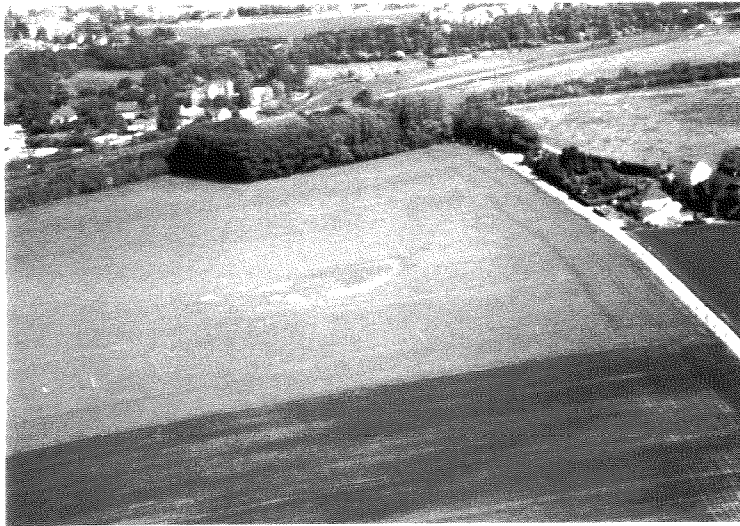
Bild 4: Luftbild des Stadtteils Dortmund-Somborn. In der Bildmitte ist ein kreisförmiger Methanaustritt an dem kümmerlichen Wachstum des Getreides zu erkennen. Dieser Standort wird in dieser Arbeit als RB 4 bezeichnet. Die dort gemessenen Emissionsraten zeigt Abb. 8.24. Aufnahme vom 11.05.1993, freundlicherweise überlassen von Herrn Kempa, Bochum.
