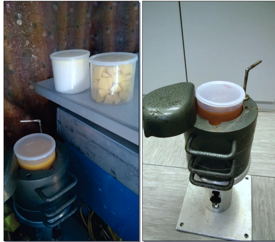
Abbildung 1-8: Lebensmittelmessgerät mit NaI(Tl)-Detektor und Bleiabschirmung
