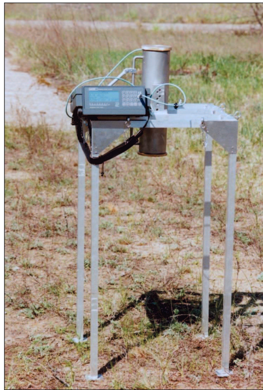
Abbildung 1-7: Bodenmessung (Ortsdosis) mit dem Messsystem MAB500
