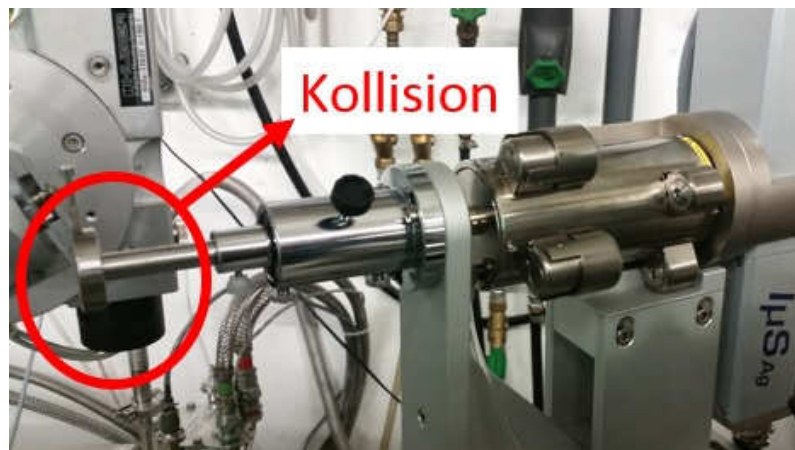
Abbildung 23: Kollision zwischen dem Kollimator der Ag-Quelle und der Probenhalterung
