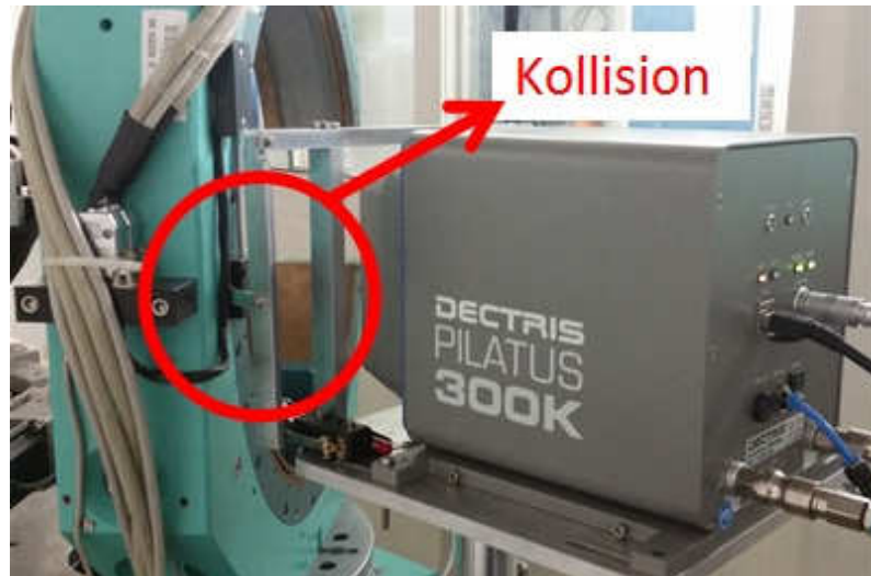
Abbildung 22: Mögliche Kollision zwischen Detektor und Eulerkreis
