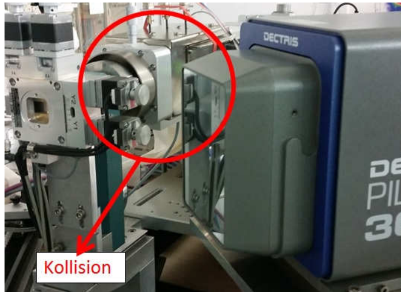
Abbildung 21: Mögliche Kollision zwischen Detektor und Kupferquelle
