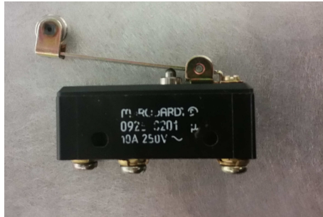
(a) Mikroschalter zur Absicherung des Pila- tus Detectors. Abbildung aus [12].
