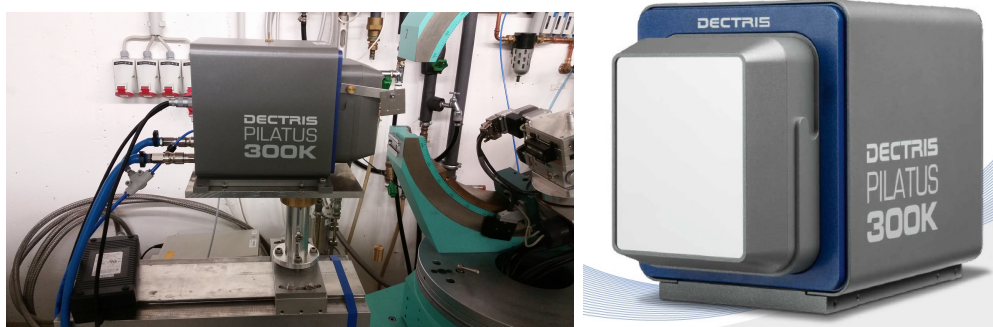
Abbildung 18: Rechts ist der Pilatus-Detektor im Labor dargestellt. Links ist ein biomeirisches Bild von dem Pilatus-Detektor gezeigt. Abbildung aus [9]
