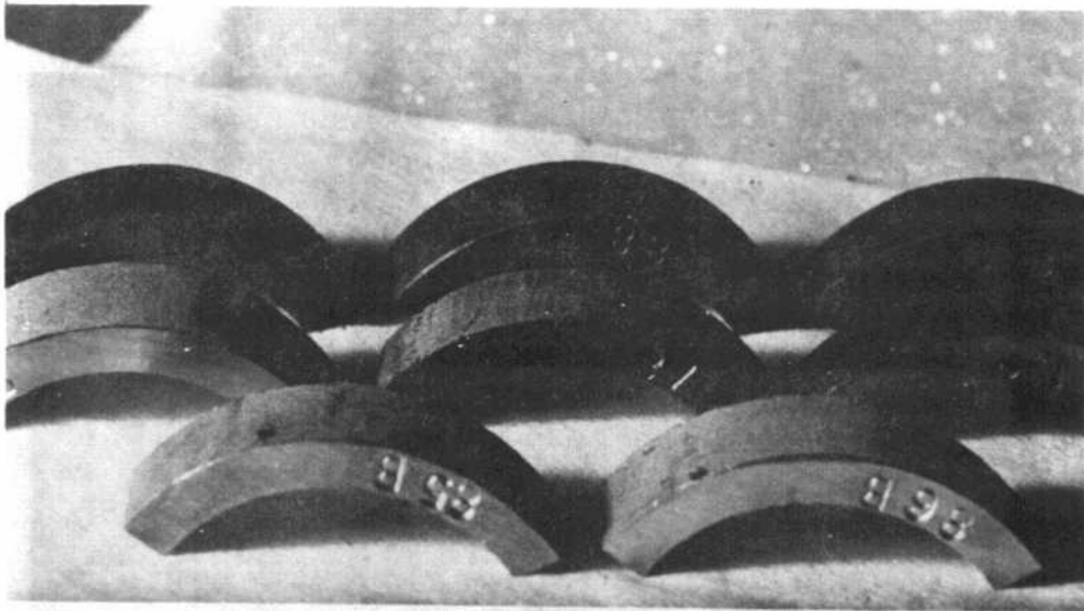
Foto 16. Rohrsegmente, untersucht unter gleicher Gasbedingung wie oben, jedoch bei verschiedenen Versuchstemperaturen.
