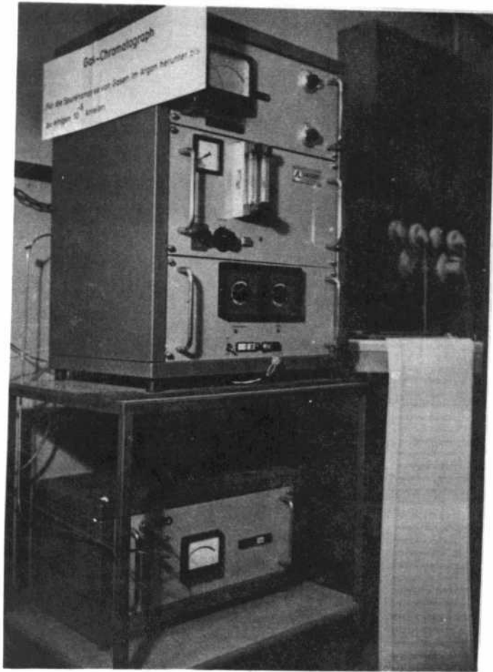
Foto 5. Gas-Chromatograph mit Schreiber. Auf dem Schrieb können einige Meßergebnisse erkannt werden.
