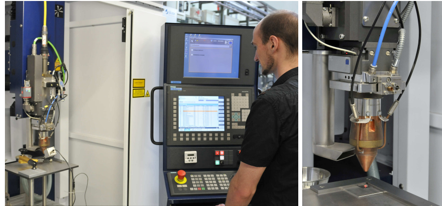
(a) Die Laserdüse ist in einen Roboterarm integriert, welcher über CNC-Programme gesteuert werden kann. Auf dem Probentisch ist zusätzlich eine Wärmebildkamera zu sehen. (b) Zu sehen ist die senkrechte Laserdüse, unter der sich ein Probentisch samt Probe befinden. Der rote Strahl kommt vom Pilotlaser.
