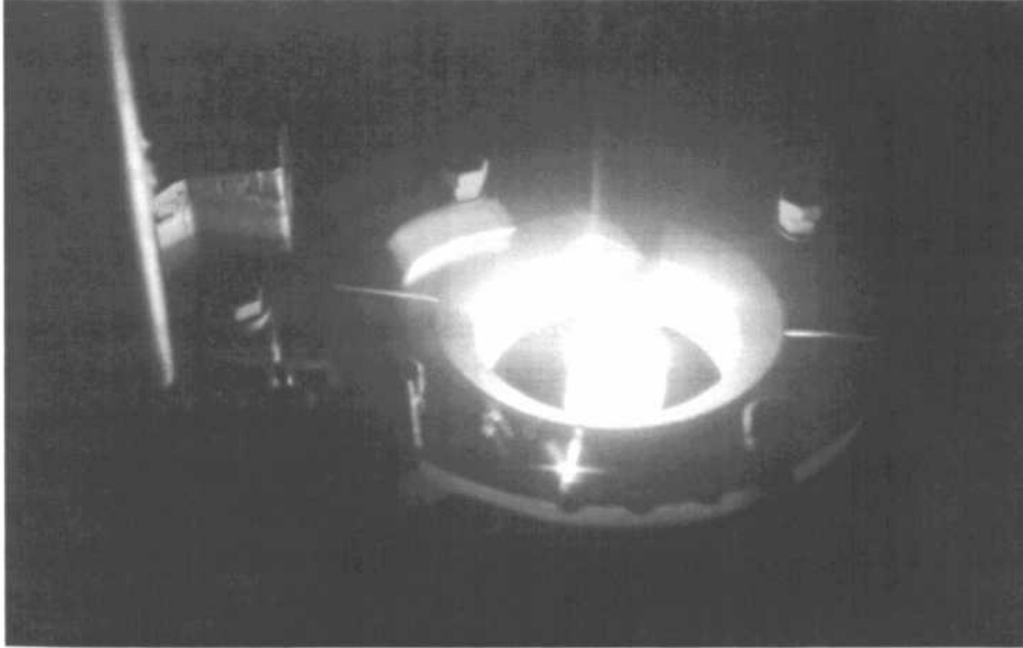
Abb. 3: Elektronenstrahlzonenschmelzen von NiAl (Wolframringkathode und zentrischer NiAl-Stab mit geschmolzener Zone)
