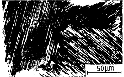
Abb. 8: Ti-50at.%Al nach Stauchverformung ( T=850^{\circ}\text{C} , \epsilon=64\% ) und Anlassen ( T=1430^{\circ}\text{C} , 5min)
