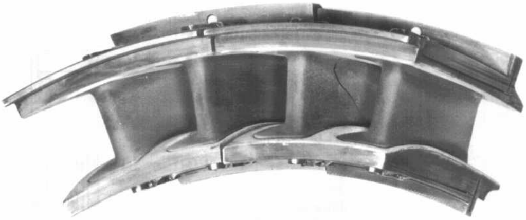
Bild 5 Hybridleitschaufel nach dem Test
