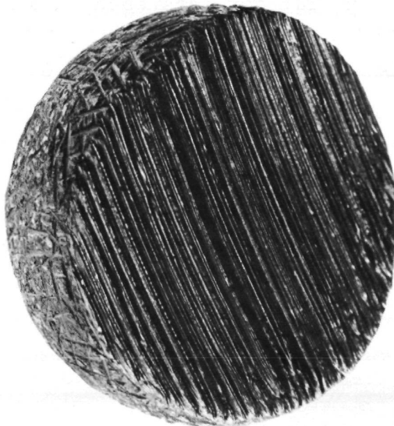
Abb. 61: Bis zur Hälfte aufgebürstete unbeladene und geschälte Brennelement-Kugel
