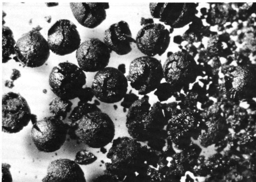
Abb. 4: Infolge von Oxidation zu U_3O_8 zerfallene UO_2 -Brennstoffkerne (Aufnahme von K. HARTMANN, ICT der KFA Jülich)
