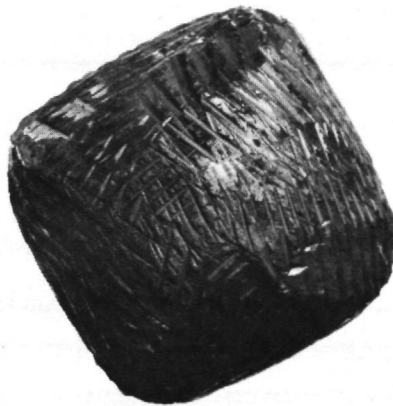
Abb. 20: Mit N = 1 geschälte BE-Kugel
