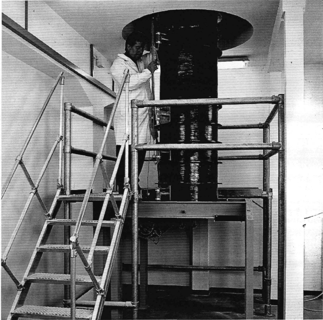
Abb. 15: Verkabelung der Radial- und Axialdruckaufnehmer LEISA II
