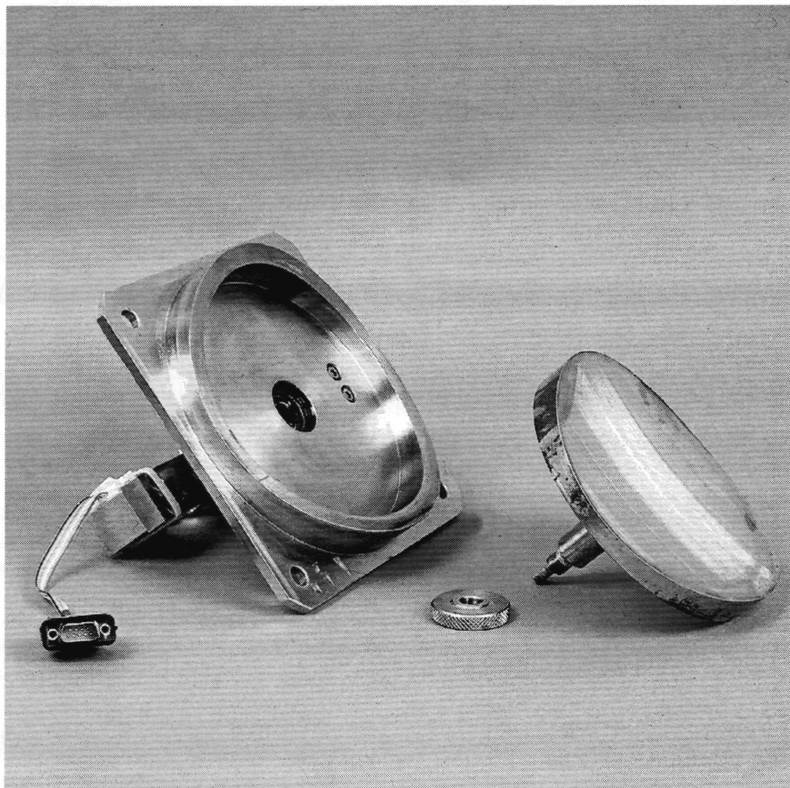
Abb. 17: Radialdruckaufnehmer LEISA II (teilweise zerlegt)
