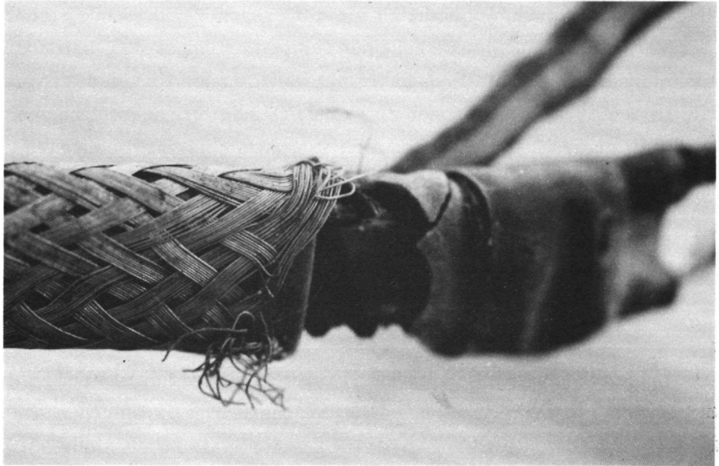
Abb. 15: Detail der strahleninduzierten Schädigung des selbstregelnden Heizbandes
