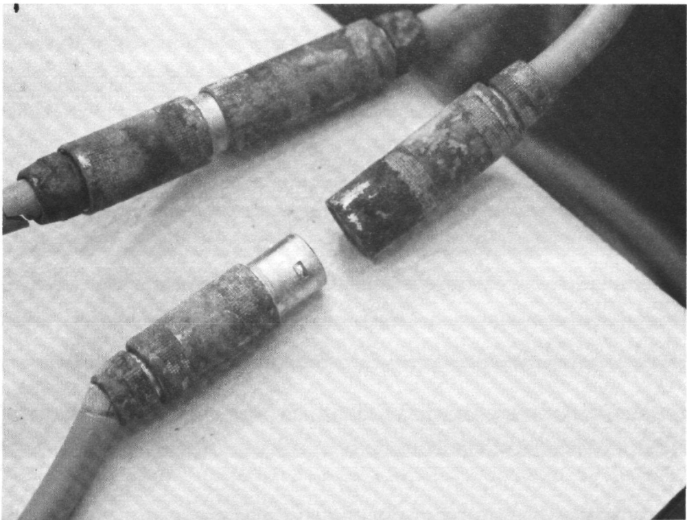
Abb. 19: Korrosionserscheinungen an den verchromten Steckverbindungen
