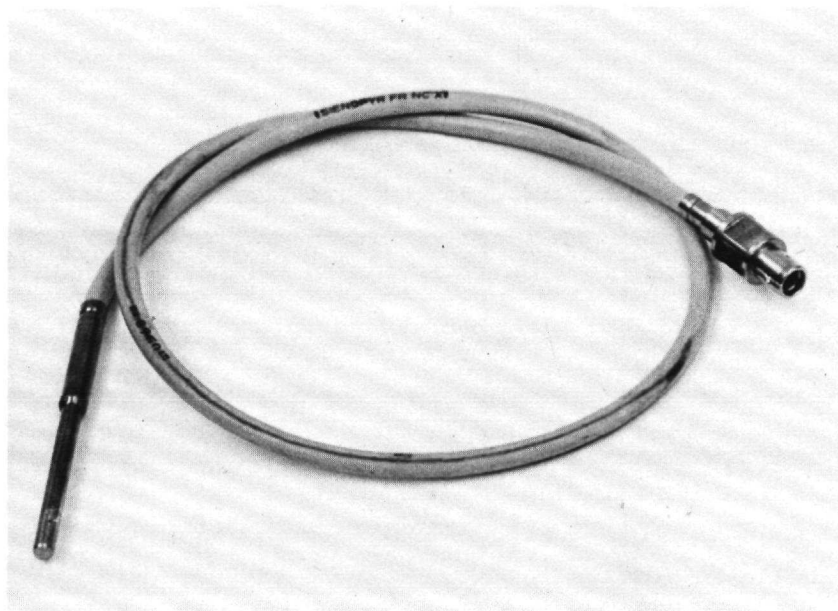
Abb. 11: Mit Anschlußstecker- und Kabel konfektioniertes Widerstandsthermometer
