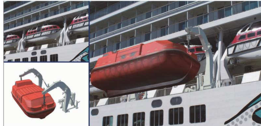
Abb. 14: Originalansicht des umzurüstenden Schiffes (links oben), 3D-Modell des einzubauenden Davits (links unten), überlagerte Mixed-Reality-Darstellung (rechts)
