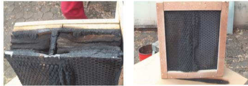
Abb. 8: Prüfkörper nach dem Brandtest
