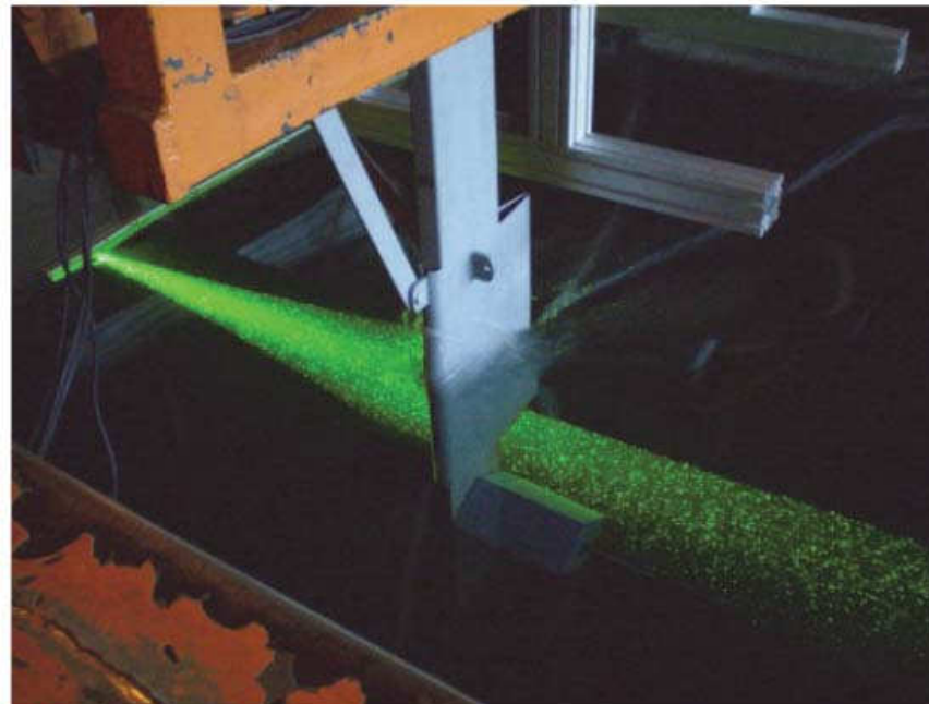
Abb. 3: Stereoskopische PIV-Messung des Geschwindigkeitsfeldes um einen Quader, das eigentliche – geschwärzte – Messobjekt liegt im Bild links vom Schwert
