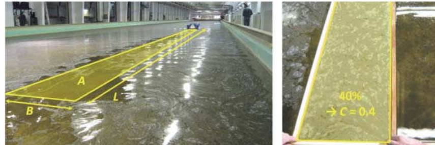
Abb. 7: Bestimmung der Skimmingfläche A (links) und der Granulatbedeckung der Versuchsstrecke im Seegangsbecken
