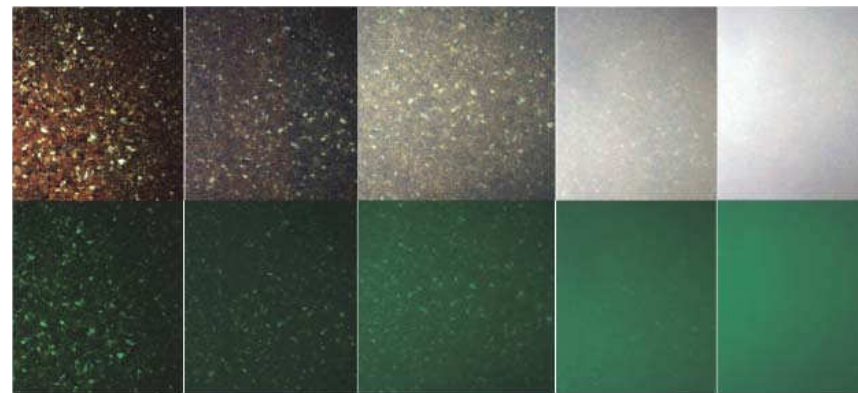
Abb. 11: Versuche mit unterschiedlichen Trübungsgraden. Links Frischwasser (0.2 FTU), rechts nach Zugabe von 200 g Tonmehl auf 20 m 3 Wasser. Obere Reihe mit Farbkorrektur.
