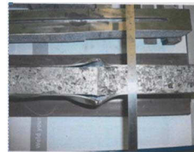
Abb. 30: T-Stoß Sandwich-Blech-Stabilitätsversagen der Deckbleche
