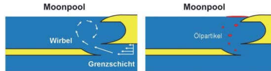
Abb. 3: Grenzschichteffekte und Wirbelbildung am SOS hängen von der Reynolds-Zahl ab (links), Aufstiegsverhalten und Phasengrenzeffekte hängen von der Morton-Zahl ab (rechts)
