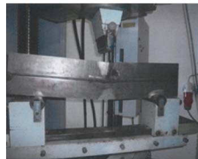
Abb. 31: Längs-Stumpfstoß Biegeversuch Stabilitätsversagen am Deckblech (punktuelle Lasteintrag)
