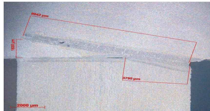
Abb. 4: Schliffbild eines T-Stoßes, Materialdicke t = 10 \text{ mm}
