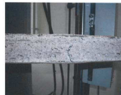
Abb. 32: Biegeprobe mit beginnendem Kernversagen
