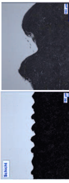
Abbildung 7: Turbulente Ausbildung der Bindezone einer Explosionsplattierung
