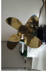
Abbildung 7: Entwickeltes dynamisches Verstellpropellersystem
