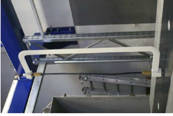
Abbildung 8: Messrahmen mit eingespanntem Musterkabel im Windkanal
