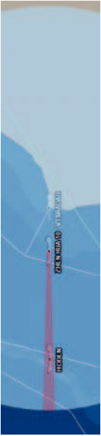
Abbildung 6: Implementierung der Radarschattendarstellung im Signalis VTS. Diese Abbildung zeigt die Implementierung der Radarschattendarstellung im Signalis VTS. Es ist zu erkennen, dass das Radar des VTS-Zentrums an Land das Schiff „Hidden“ im rot dargestellten Bereich nicht erkennen kann. Aufgrund der Nutzung des Radardatenaustauschs mit der Zhen Hua 10 ist das Radarziel der „Hidden“ dennoch im Verkehrslagebild sichtbar.
