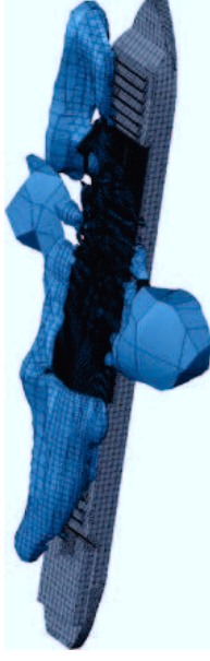
Abbildung 13: Methanausbreitung nach 14s bei Abriss der Ladeleitung
