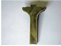
Abbildung 10: Explosivplattierter Grundkörper für ein Schiffsdieselmotor-Ventil
