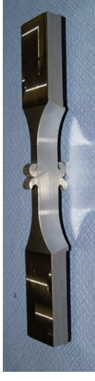
Abbildung 21: Reibschweißprobe mit Wulst
