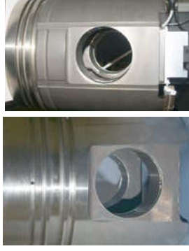
Abbildung 23: linke Seite: Kolben Variante 1 (Diesel- und Schwerölbetrieb), rechte Seite: Kolben Variante 2 (Gasbetrieb)
