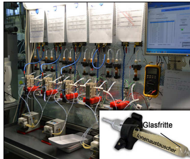
Abbildung 3.5: Darstellung des Langzeitteststandes mit autonomer Wasser- und Spannungsversorgung zur simultanen Messungen mehrerer Zellen. Unten rechts ist ein mit Lewatit® TP 207 befülltes Quarzglasröhrchen zu sehen.
