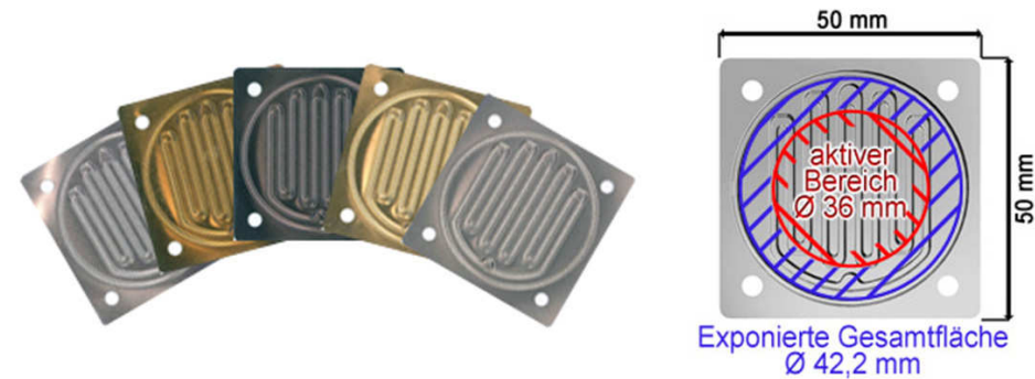
Abbildung 3.3: Links: Auswahl an verschiedenen Proben im Rundzellenbipolarplatten-Design. Rechts: Darstellung der Flächenbemaßungen.
