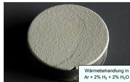
Abbildung 5.30: Fotografie des WDS-Systems hergestellt aus Pulver G und YSZ nach der Wärmebehandlung in Ar-Atmosphäre mit 4 % \text{H}_2 und 2 % \text{H}_2\text{O}
