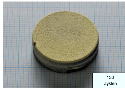
Abbildung 4.3: Vergleichsschicht aus YSZ nach der Ofenzyklierung bei 1100 °C mit einer Hochtemperaturphase von 2 h pro Zyklus.
