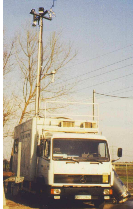
Abbildung 1: Mess-Lkw des Forschungszentrums Jülich. Zur Durchführung der Dauermessungen am Standort Kurpark das Messfahrzeug auf dem Gelände der Stadtgärtnerei unmittelbar neben dem Kurpark platziert. Der Abstand zwischen Mess-Lkw und Messort des DWD auf dem Kurparkgelände betrug ca. 30 m.
