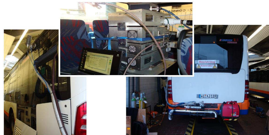
Abbildung 32: Integration mobiler Messtechnik zur Charakterisierung des Abgas-Emissionsverhaltens eines Busses unter realen Betriebsbedingungen, entnommen aus: [Pütz, 2014].
