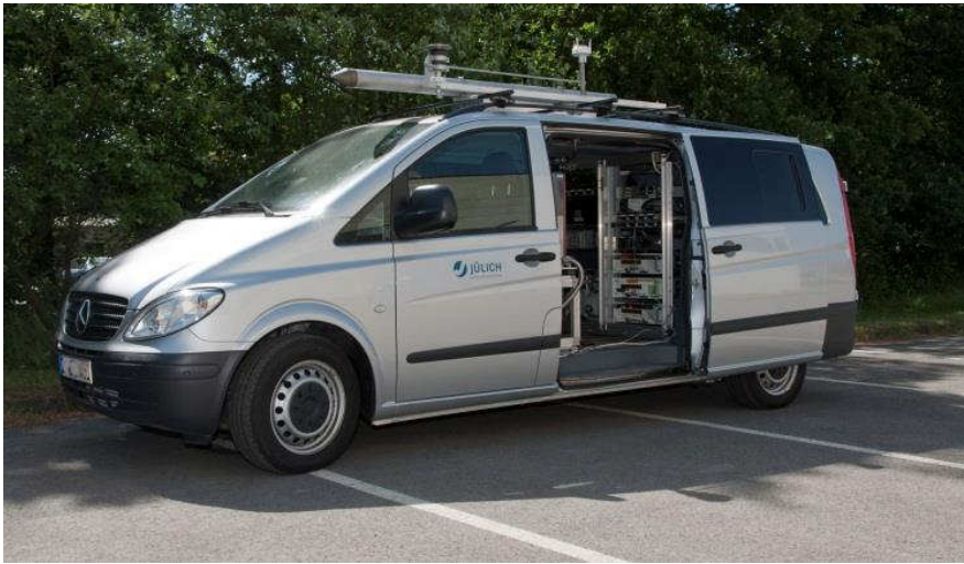
Abbildung 4: Das mobile Messlabor des FZ Jülich (MOBILAB). Basis ist ein umgebauter und adaptierter Daimler-Benz Vito mit Dieselantrieb und verstärkter Generatorenleistung.
