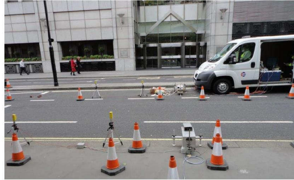
Abbildung 30: Messaufbau für Straßenrandmessungen mittels Absorptionsmessung im Abgasbereich hinter Fahrzeugen im realen Verkehr (aus: [Carslaw et al, 2013]).
