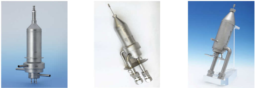
Abbildung 15.4: Katalytbrenner-Reaktoren der Generationen 2.3, 3 und 4 (v.l.n.r.) des IEK-3.
