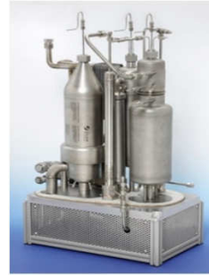
Abbildung 15.5: Package 2: Brenngaserzeugungssystem mit einer thermischen Leistung von 28 kW.
