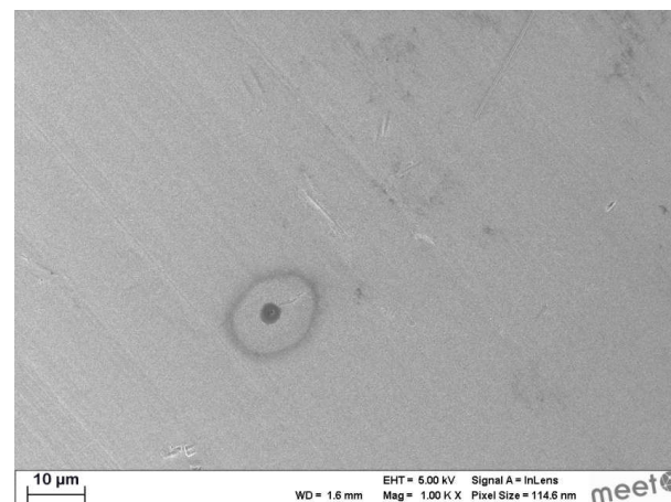
Abbildung 4-25: REM-Aufnahme der Probenoberfläche (ZnO:Al auf MEET-Folie) nach CA-Messung.
