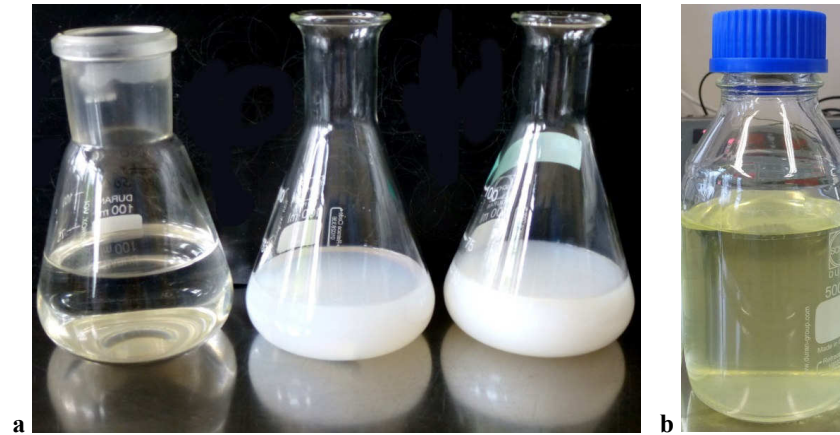
Abbildung 4-3: Sol von ZnO:Al (links) im Vergleich mit Titandioxid-Sol-Synthesetests (Mitte, rechts) (a) und SLT-Sol hergestellt nach weiterentwickelter Syntheseroute (b).
