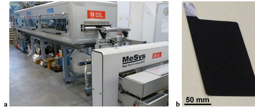
Abbildung 6-1: Trockentunnel der Bandbeschichtungsanlage mit angeschlossenem Ultraschallmesssystem zur Schichtdickenbestimmung (a) und Zuschnitt der Graphitelektrode auf Aluminiumfolie (b).
