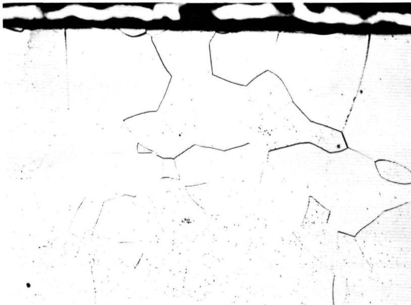
Abb. 30: \text{HNO}_3 -HF-Glycerin-Lösung 200:1 Niob-Probe in Blei bei 422^\circ - 1000^\circ\text{C} , 100 h, bei der maximalen Temperatur von 1000^\circ\text{C} , Gesamtversuchsdauer 213 h.
