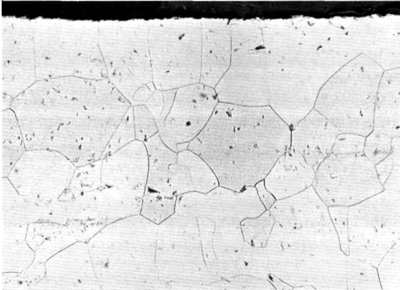
Abb. 29: 200:1 Niob-Probe vor der Untersuchung (in nicht behandeltem Zustand)
