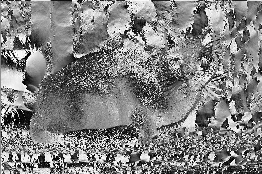
Abbildung 3.5.: Aus dem Strukturtensor extrahierte Richtungen der minimalen Gradienten. Schwarz entspricht einem Winkel von  $0^\circ$ , weiß entspricht einem Winkel von  $180^\circ$ .  $0^\circ$  bedeutet, dass der Gradient waagrecht verläuft. Bei  $90^\circ$  verläuft er senkrecht.
