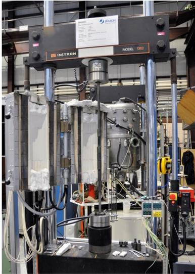
Die Maschine besitzt ein axial montiertes Dehnungsmessgestänge, das nach unten aus dem Ofen herausgeführt wird und mit einem LVDT (linear variable differential transducer; Messbereich:  $\pm 5$  mm) verbunden ist. Die Beheizung erfolgt über einen dreizonigen Widerstandsofen der Firma Heraeus, mit 2 kW Heizleistung je Zone, der vertikal zweigeteilt ist. Die Prüftemperatur kann damit zwischen RT und ca. 1000 °C eingestellt werden.
