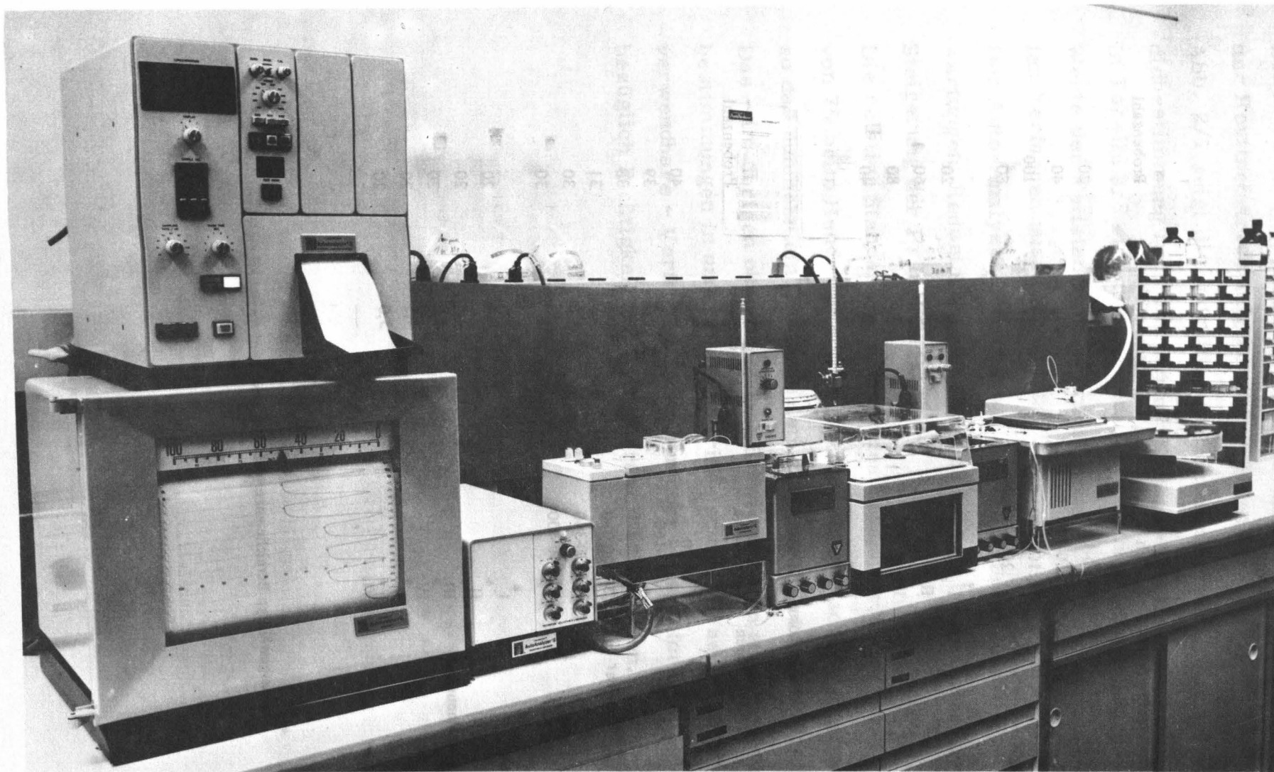
Abb. 1 Automatisierter Meßplatz zur Jod-Analyse der Gras- und Filterproben
