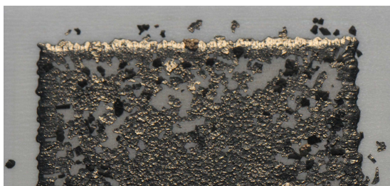
Abb. 4.21: Foto der bei 850 °C für 3 h an Luft gesinterten Siebdruckschicht der Paste LSCF (0,3 \mu\text{m} ) #1 aus nanostrukturiertem LSCF Pulver ( d_{50} \approx 0,3 \mu\text{m} ) auf YSZ Substrat.
