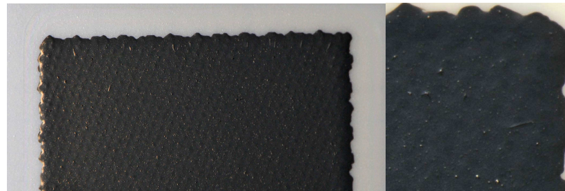
Abb. 4.24: Fotos der bei 850 °C für 3 h an Luft gesinterten Siebdruckschicht der Paste LSCF ( 0,3\ \mu\text{m} ) #4 aus nanostrukturiertem LSCF Pulver ( d_{50} \approx 0,3\ \mu\text{m} ) auf YSZ Substrat.
