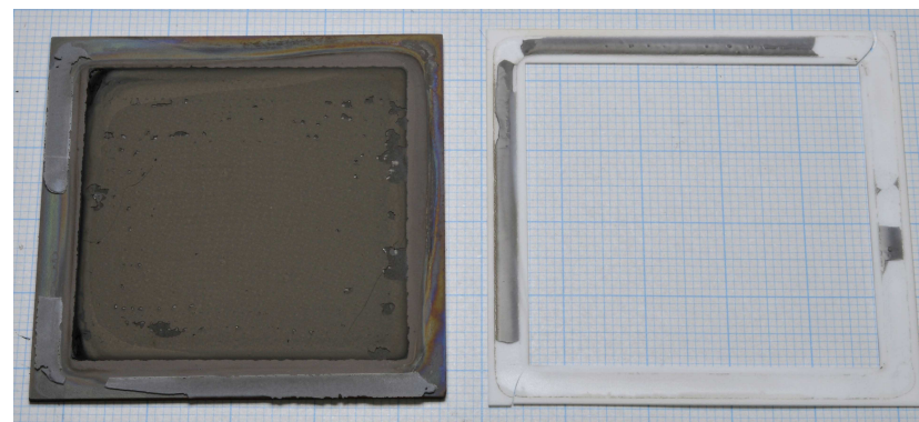
Abb. 5.13: Zelle DU_1309-016 B_04a-02 mit bei 950 °C in situ aktivierter LSC Kathode und Rahmen mit Glaslot nach Zelltest am IEK-9.
