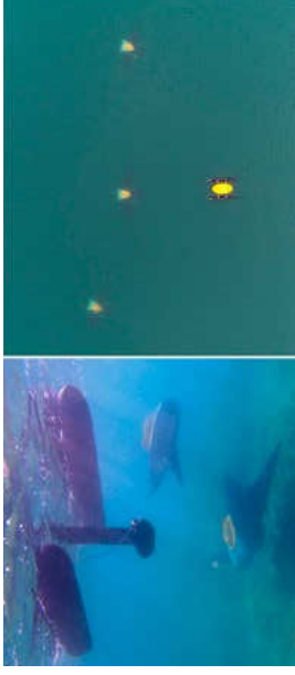
Abbildung 10: Autonome Schwarm-Operation mit 3 Manta-AUVs und einem mitfliegenden ASV; links: UW-Startvorbereitung, rechts: Formationflug, Luftaufnahme mittels Flugdrohne
