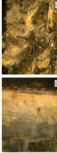
Abb. 6: Bearbeitung von Kevlar mit 2 \mu\text{m} Laserstrahlung bei 180 W und einer Vorschubgeschwindigkeit von 75 mm/min unter \text{N}_2 -Schutzgasatmosphäre.
