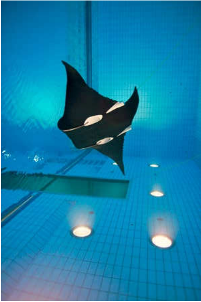
Abbildung 7 : Experimentelle Erprobung und Optimierung des Flügelantriebs mit dem M_0 - Manta im großen Sprungbecken des Olympiazentrums Berlin
