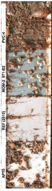
Abbildung 10: Bewuchs auf Langzeit-Testplatten aus 2016 von IFAM und Momentive im Vergleich zum Markprodukt und einem unbehandelten Primer am 20. Juli 2017.
