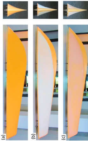
Abbildung 13: Bugsegmente – Blick auf Steuerbordseite (links) und Steven (rechts). (a) Starre Oberfläche – Standardlock; (b-c) nachgiebige Oberfläche mit „Blubberrandschichten“ von (b) 3 mm und (c) 10 mm
