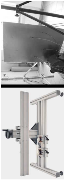
Abbildung 4.1: links: Messaufbau zur Bestimmung des Biegeverlustfaktors nach [1]; rechts: Messaufbau zur Bestimmung der Körperschallnachhallzeit in Anlehnung an [9]
