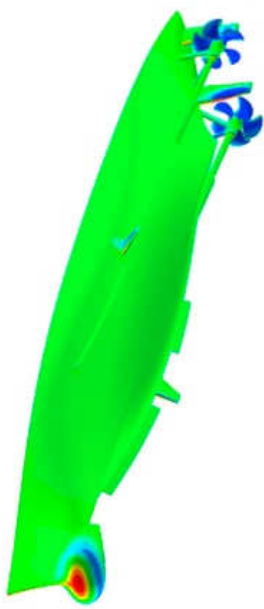
Abbildung 8: DTMB 5415 kombiniert mit Propeller CPP 1304
