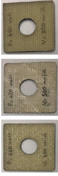
Abb. 8: Mit dem Yb-Laser bei 420 W bearbeitetes GFRP. Vorschubgeschwindigkeit: 400 mm/min, 500 mm/min, 350 mm/min. Materialstärke: 1,2 mm, 1,5 mm, 3 mm.
