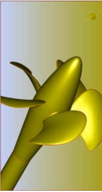
Abbildung 1: Gegenstand der Freifahrt-Berechnungen: CPP 1304. Die Nabe läuft wie üblich stromaufwärts in eine Zuluftbohle aus.
