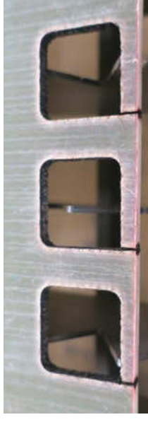
Abb. 9: Mit dem Tm-Laser bei 200 W geschnittenes GFRP.
