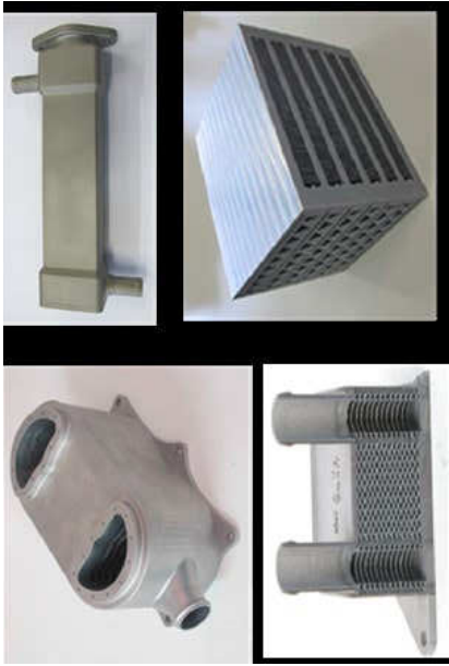
Abbildung 11: Additiv gefertigter Stapscheiben-Luft-Luftkühler (360 x 125 x 180 mm), Abgaskühler (240 x 120 x 46 mm), Stapscheiben-Ölkühler (120 x 110 x 68 mm) und Pakekühlerauschnitt (110 x 86 x 90 mm, v.l.o.n.r.u.)
