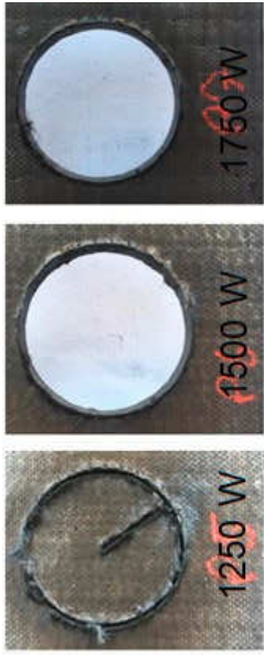
Abb. 5: Bearbeitung von 2 mm starkem CFRP mit Laserstrahlung bei einer Wellenlänge von 1 \mu\text{m} , einer Vorschubgeschwindigkeit von 1000 mm/min und Laserleistungen von 1250 W, 1500 W und 1750 W.
