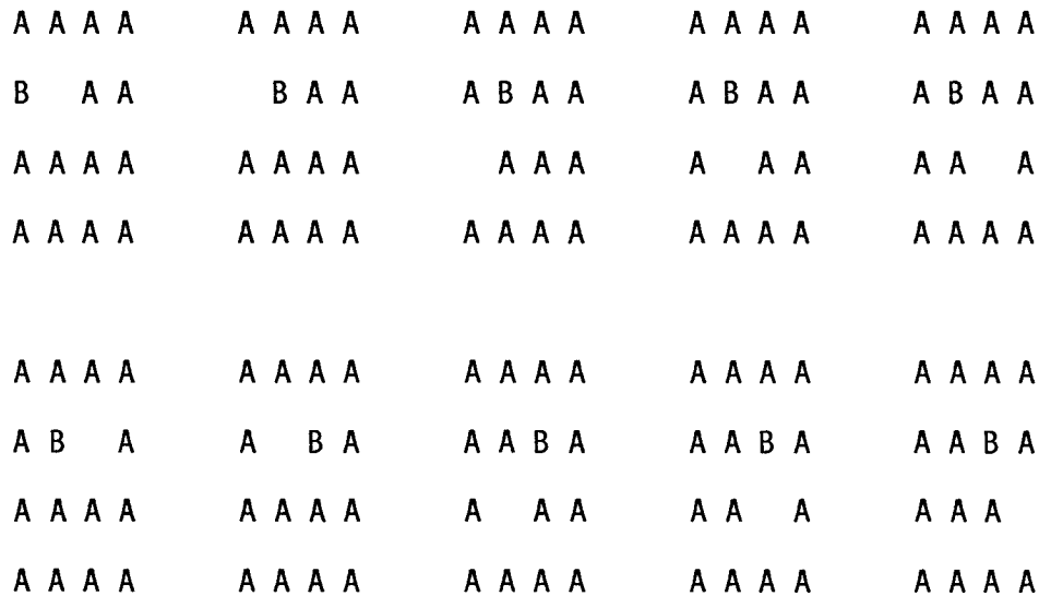
Abbildung 2.2 Schematische Darstellung des Leerstellenmechanismus.
