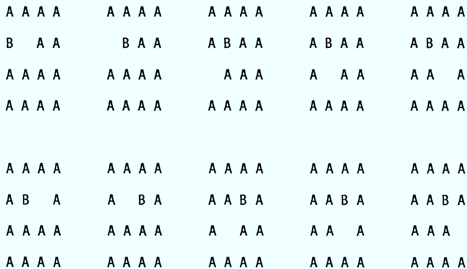
Abbildung 2.2 Schematische Darstellung des Leerstellenmechanismus.
