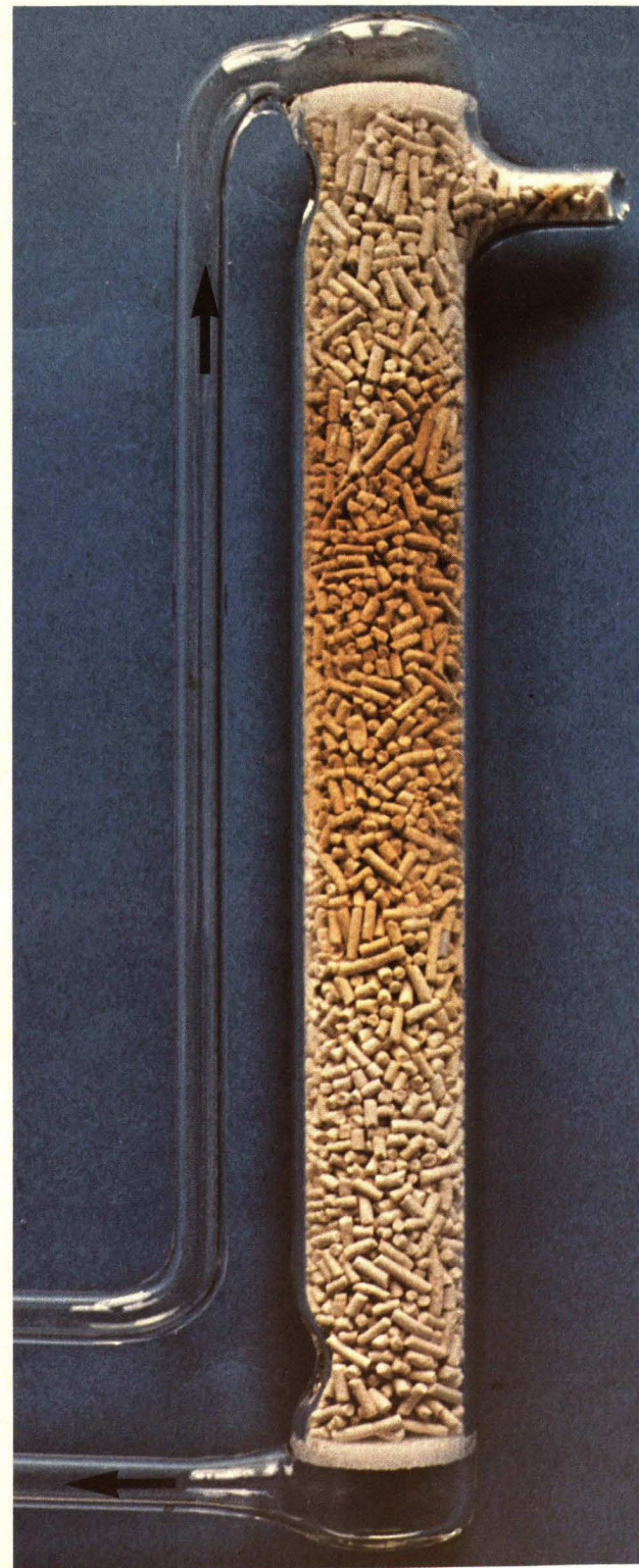
Abb. 9: Molekularsiebsäule während der Beladung mit feuchtem \text{NO}_x -Luft- gemisch
