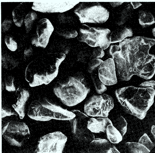
Abb. 39.1: Dunkler Sand, Ke 1 in Tab. 3 unter einem Elektronenmikroskop
