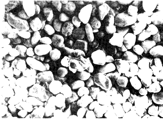
Abb. 24.1: Dunkler Sand No 1 in Tab. 1 unter einem Elektronenmikroskop (Sandkörner sind mit Graphitstaub überzogen)
