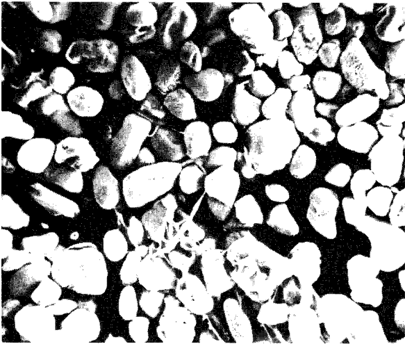
Abb. 27.1: Ferromagnetischer Anteil von Probe No 1 in Tab. 2 unter einem Elektronenmikroskop
