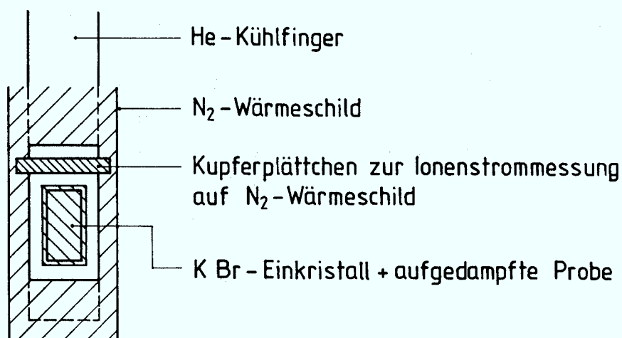
Abb. 7: Anordnung des Kupferblättchens an das N 2 -Wärmeschild zur Ionenstrommessung
