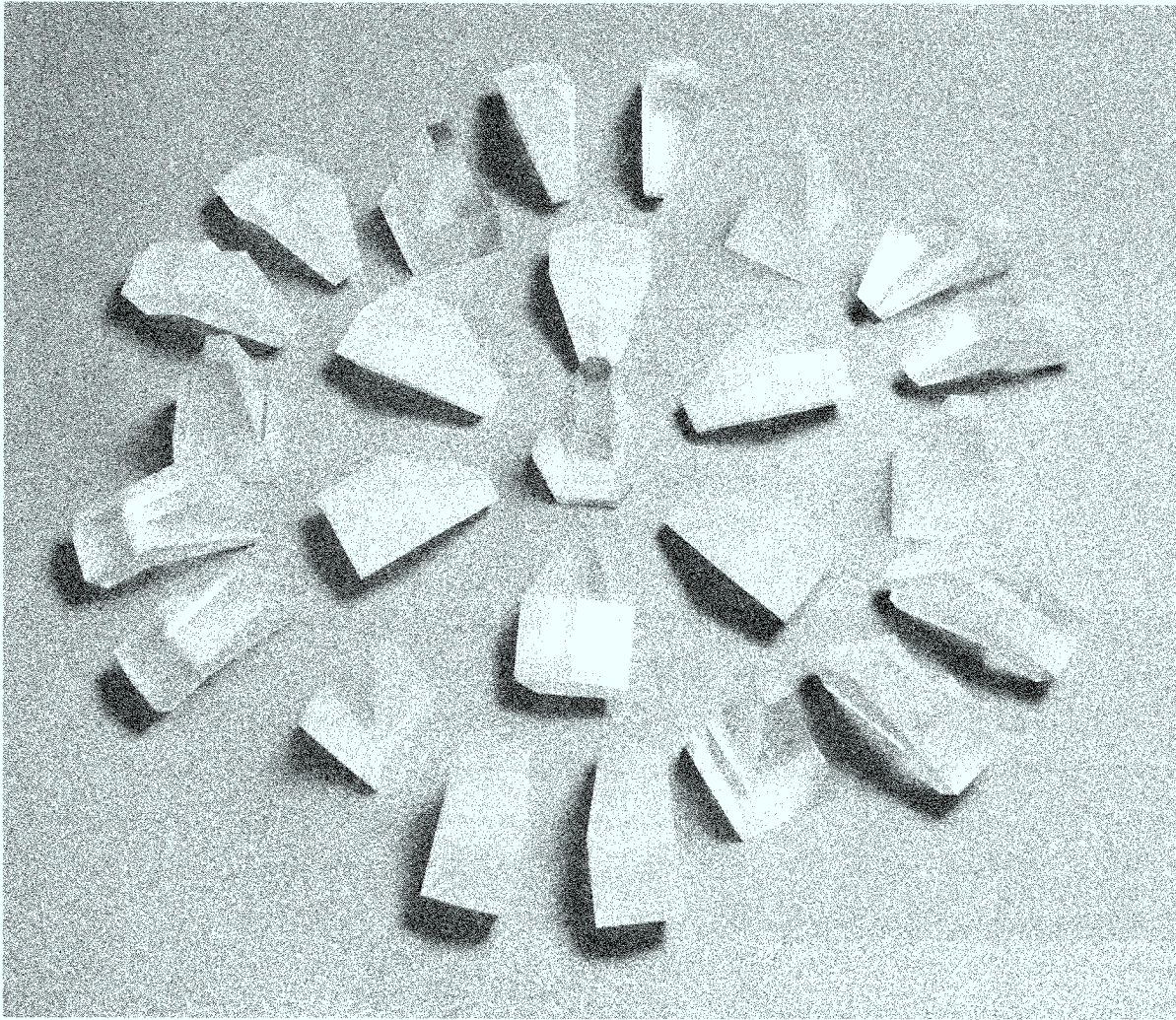
Bild 43 25 BGO-Kristalle für das \gamma -Kalorimeter. Im äußeren Ring sieht man K1- und K2- Kristalle, im Inneren Ring K3- Kristalle und in der Mitte den Polkristall K4.
