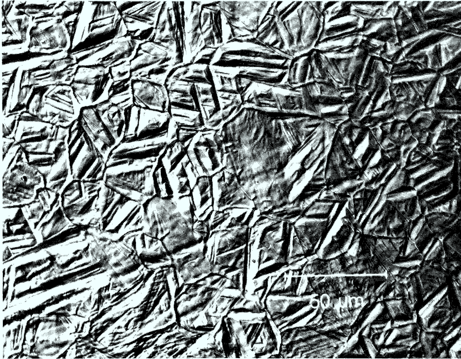
Abb. 1: Gefügebild des martensitischen Stahls DIN 1.4914 nach der Endwärmebehandlung
