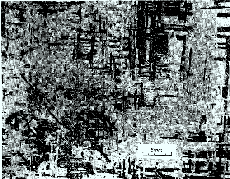
Abb. 7.9: Polierte und geätzte Platte des Meteoriten Gibeon. Die Platte ist nahezu parallel zu einer Würfelfläche des Taenits geschnitten, so daß die oktaedrischen Lamellen etwa senkrecht aufeinander stehen. Einige „tesserales“ Lamellen kreuzen den \gamma -Fe,Ni-Kristall diagonal.
