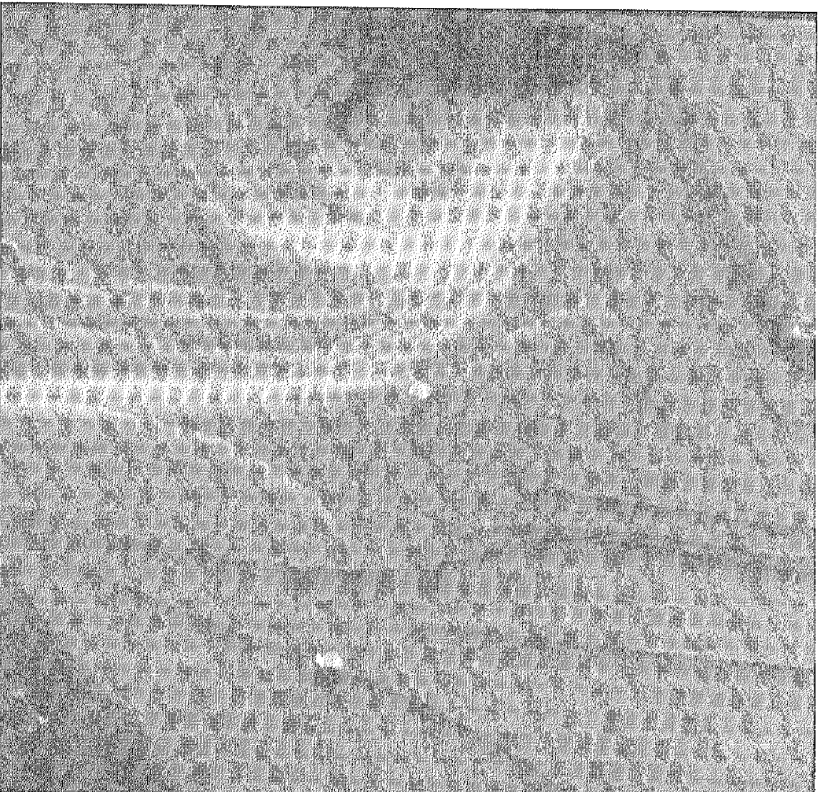
Abb. 5.29: Von der Tunnelspitze erzeugtes Loch in der Oberfläche bei einer Proben­temperatur von 90°C. Wegen der Oberflächendiffusion bilden sich sofort hexagonale Strukturen aus. Bildausschnitt 1100 \times 1100 \text{ \AA} , differenziert.
