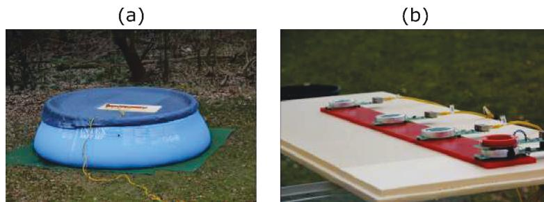
**Abbildung 5.1:** (a) Ein mit Wasser befüllter Pool. Auf der Oberfläche befinden sich die Spulen. (b) Die vordere Spule erzeugt das primäre Magnetfeld, die folgenden drei Spulen können das Gesamtmagnetfeld messen. Für das vorgestellte Experiment wurde nur die zweite Spule zur Messung verwendet. Bildquelle: [Mes14]
