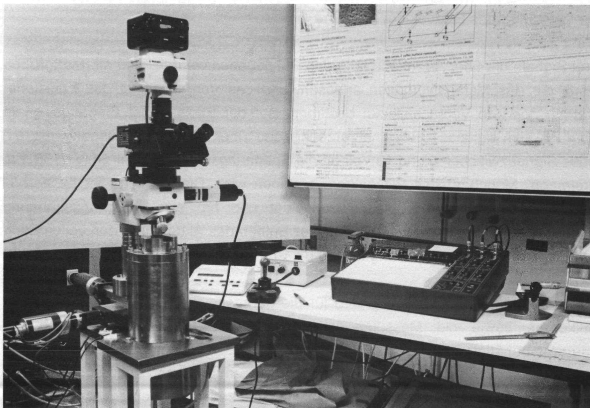
Abb. 3.7: Lichtmikroskop und Verformungsapparatur mit Steuer- und Erfassungsgeräten
