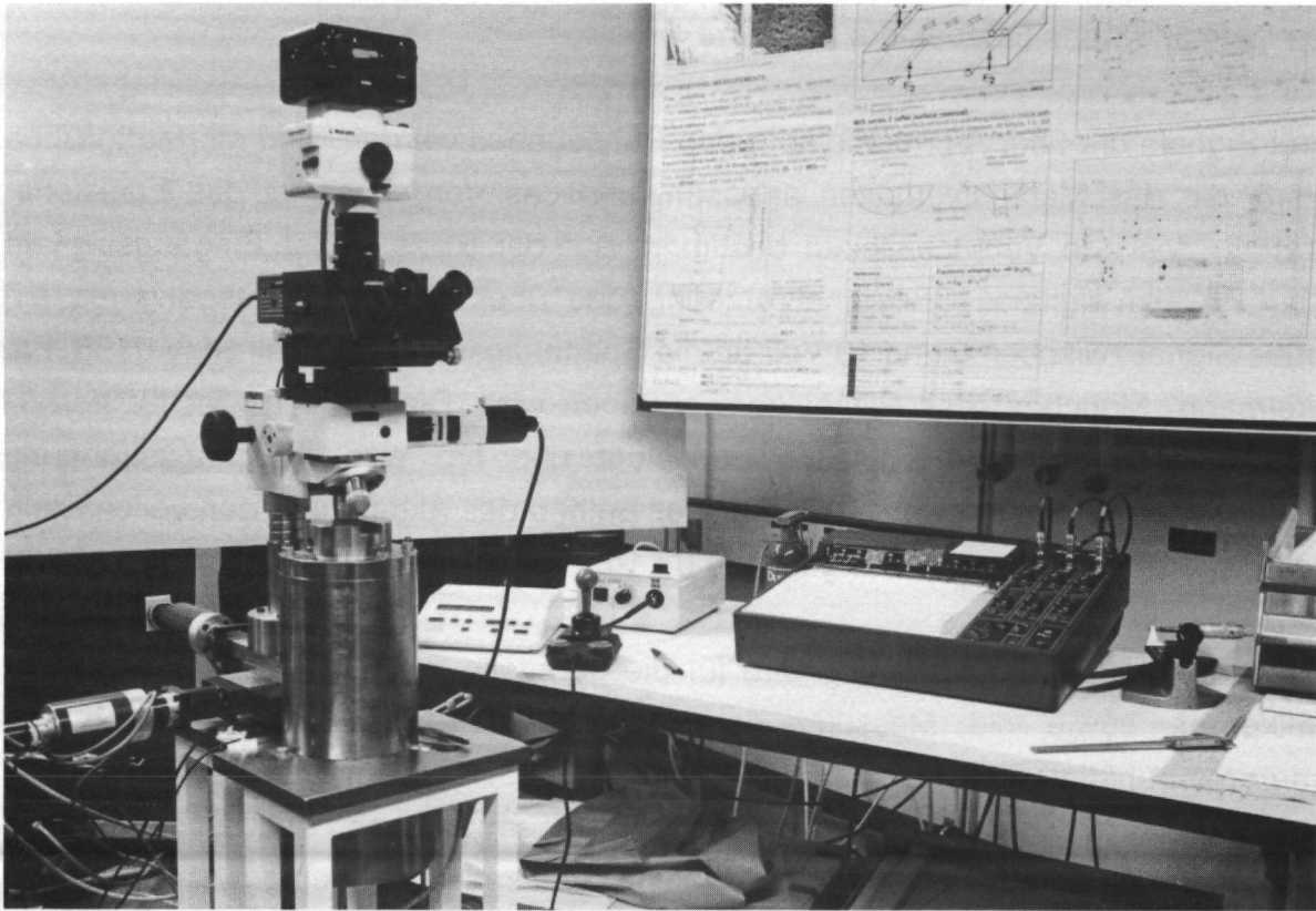
Abb. 3.7: Lichtmikroskop und Verformungsapparatur mit Steuer- und Erfassungsgeräten
