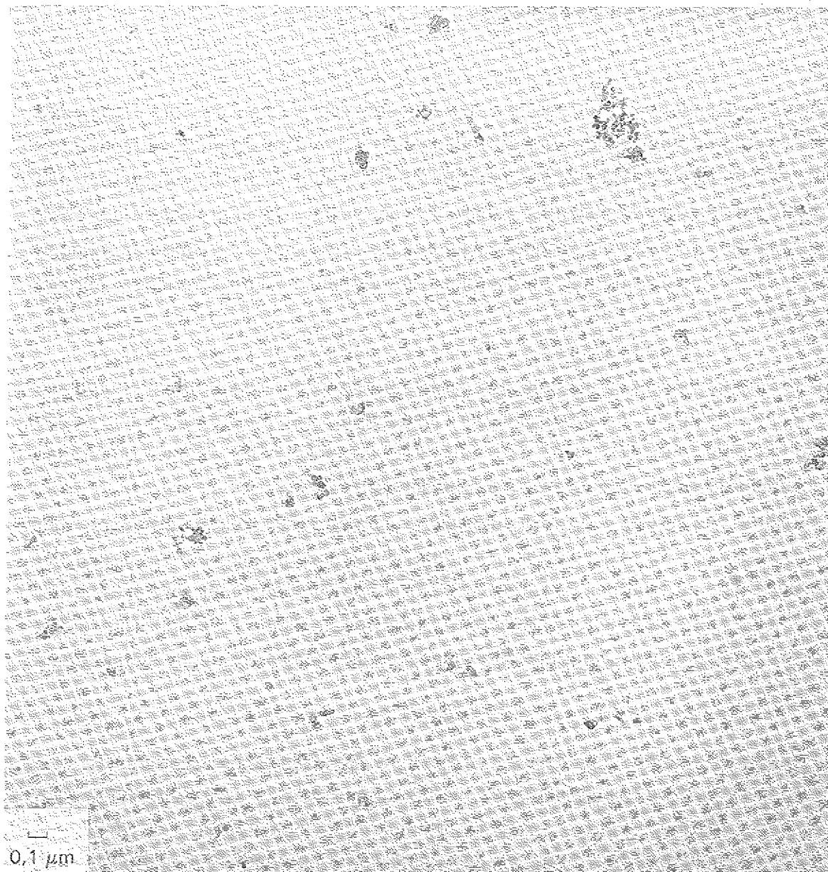
Bild 7.6: TEM-Aufnahme von Teilchen eines realen Verbrennungsaerosols. Das Bild zeigt die Belegdichte bei einer Probenahmezeit von 10 min.
