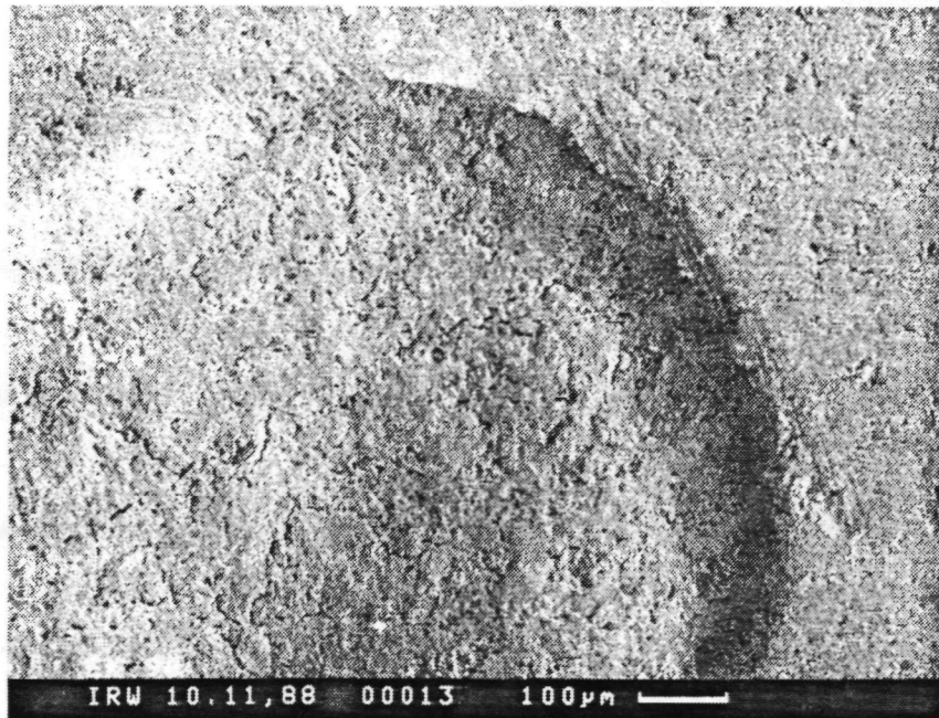
Abb. 36. Erosions-Krater nach Belastung von EK 98 in Luft: Bei sehr hohen Belastungen sind nur am Kraterboden geringe Anzeichen von Rißbildung.
