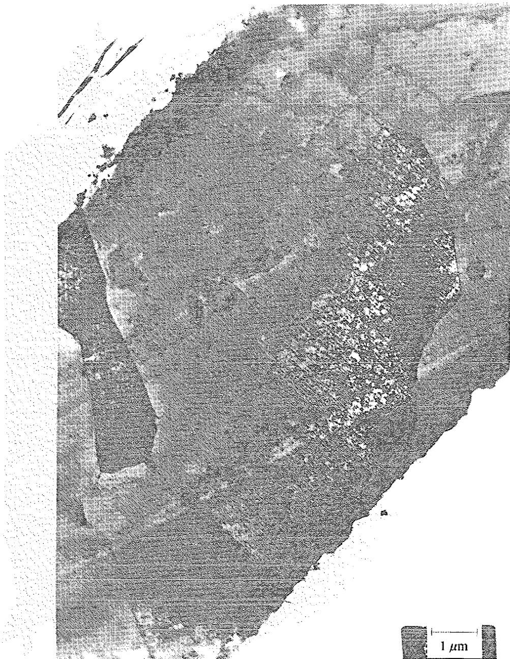
Abb.4.40: TEM-Aufnahme der AlSi 0.01 Cu 0.005 10x10-Struktur nach Tempern der Probe für 5' bei 550°C. Die Korngröße ermittelt sich zu 2,4 μm bei einer Schichtdicke von 0,8 μm.
