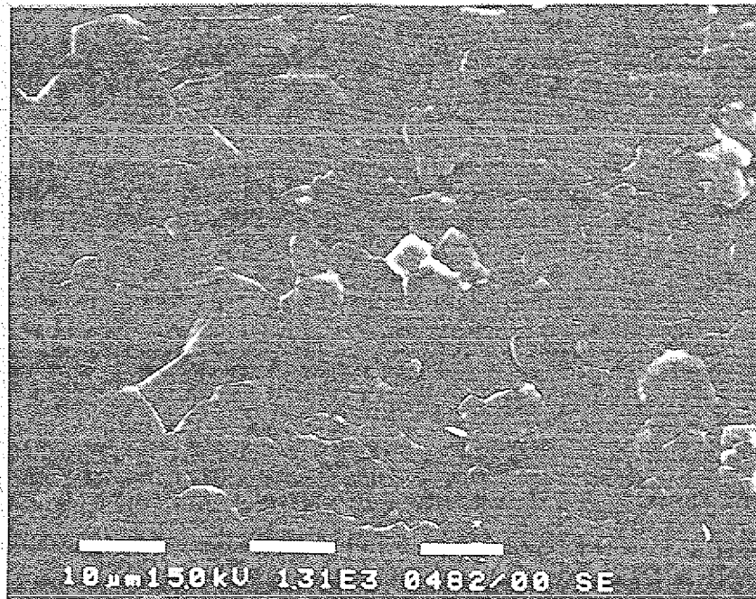
Abb.4.3: REM-Aufnahme der Oberfläche einer bei Raumtemperatur aufgedampften 8,8 \mu\text{m} dicken Al-Schicht nach Tempern der Probe bei 450°C für 30'. Die Vergrößerung beträgt 1300, der weiße Balken entspricht 10 \mu\text{m} .
