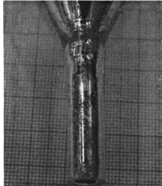
Abb. V.1.15.: Impfling mit Ga-Flecken im offenen Quarztiegel
