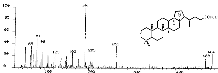
Abb. 6.3.1.8: Massenspektrum von 17 \alpha ,21 \beta -dihomo-Hopancarbonsäure als Methylester.
