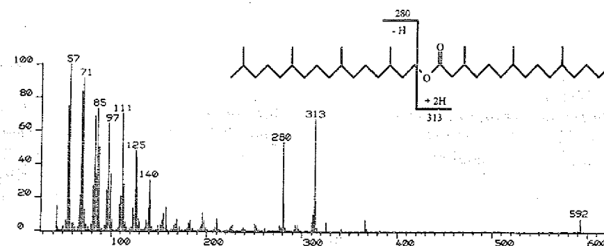
Abb. 4.3.2.9: Massenspektrum des Wachsesters aus C 20:0 -Carbonsäure und C 20:0 -Alkohol.
