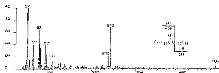
Abb. 4.1.3.18: Massenspektrum des Wachsesters aus C_{15:0} -Carbonsäure und C_{17:0} -Alkohol.
