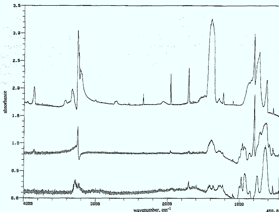
Abb. 5.27: IR-Spektren des C_2H_2 vor (oben, 10K) und nach (mittig, 10K) der Tieftemperatur-Niederdosis-Bestrahlung bzw. nach der Ethin-Sublimation bei T \approx 75K (unten).
