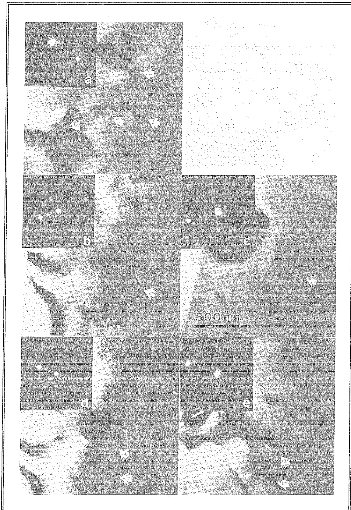
Abbildung 8.36: Hellfeldaufnahmen eines Gebietes in einer verformten Probe. Die zur Abbildung benutzten reziproken Gittervektoren sind im Text aufgeführt. (b) und (c) demonstrieren die starke, (d) und (e) die schwache Auslöschbedingung.
