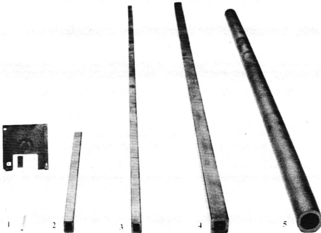
Abb. 3.10: 1) SiSiC- Vierkantstab 3,5 mm x 4,5 mm x 50 mm 2) SiSiC- Vierkantrohr 23 mm x 17 mm x 1700 mm 3) SiSiC- Vierkantrohr 23 mm x 17 mm x 1700 mm 4) SiSiC- Vierkantrohr 30 mm x 30 mm x 1700 mm 5) SiSiC- Rundrohr \varnothing 43,5 mm x 30 mm x 1550 mm
