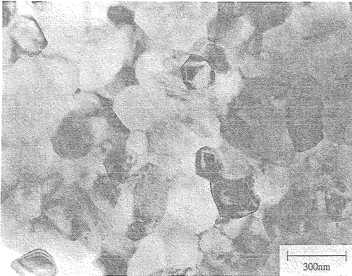
Abb. 5.47 TEM-Hellfeldbild einer splatgekühlten \text{Al}_{64}\text{Cu}_{22}\text{Co}_{14} -Probe.
