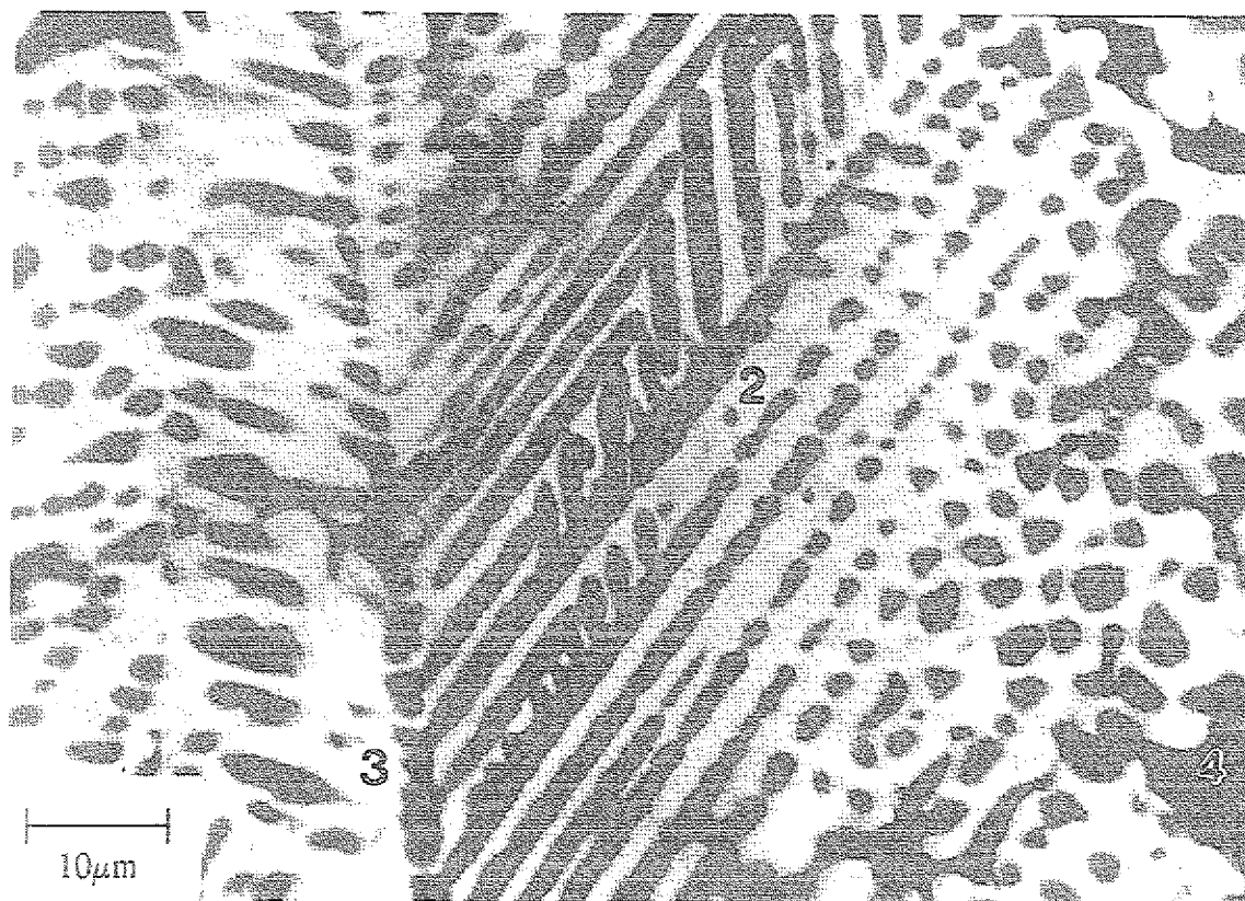
Abb. 5.11 REM-Bild des Gefüges der maximal unterkühlten Al 60 Cu 34 Fe 6 -Probe, deren Temperatur-Zeit-Profil in Abb. 5.10a gezeigt wurde.
