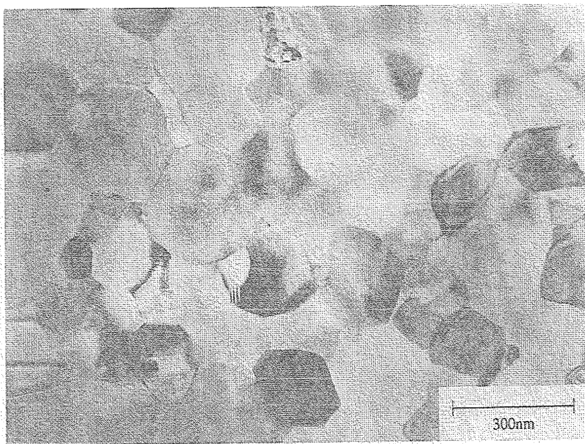
Abb. 5.42 TEM-Hellfeldbild einer splatgekühlten \text{Al}_{62}\text{Cu}_{25.5}\text{Fe}_{12.5} -Probe.
