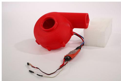
Abbildung 2.8.: Außenläufermotor in einem 3D-gedruckten Gehäuse.
