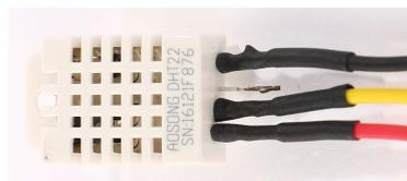
Abbildung 2.3.: Ein DHT22-Sensor.
