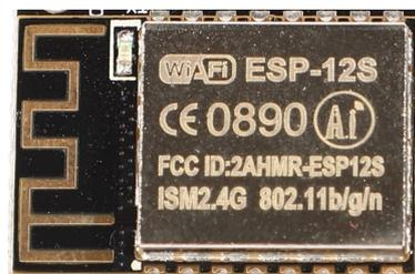
Abbildung 2.2.: Ein ESP-12S WiFi-Modul auf einem Adafruit Huzzah Feather Board (Ausschnitt aus Abbildung [2.1](#)).
