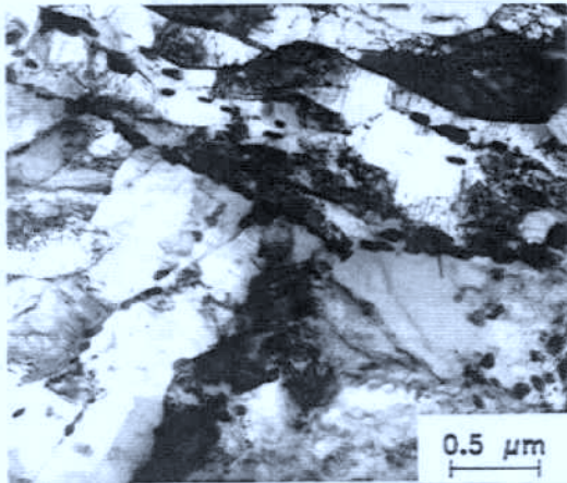
a) angelassener Martensit mit Carbiden auf den Austenitkorngrenzen
