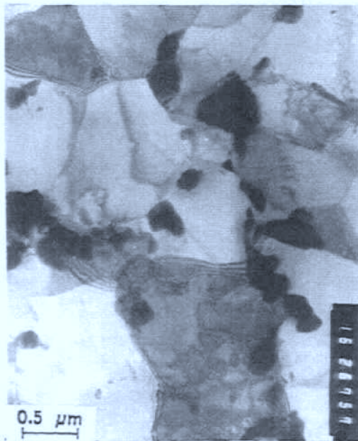
Abb. 4.4.1-52: TEM-Metallfolie zeitstandbeanspruchter CQM-Probe (637°C, 120 MPa, 7348 h, 25,3% Bruchdehnung, Schaft, Lieferzustand): fortgeschrittene Polygonisation der Subkornstruktur, geringe Versetzungsdichte
