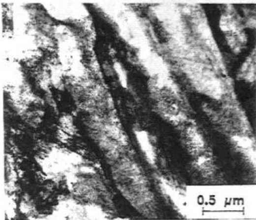
Abb. 4.4.1-18: TEM-Metallfolie von CQM ( T_A=970^\circ\text{C} ): Martensitlattenstruktur
