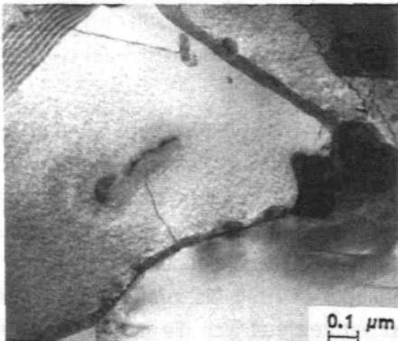
Abb. 4.4.1-65: TEM-Metallfolie zeitstandbeanspruchter CQM-Probe (650°C, 120 MPa, 66 h, 35,4%, Schaft, 835°C angelassen): vereinzelte Versetzungen an M_{23}C_6 o. MX, geringe Carbidbelegung auf Subkorngrenzen
