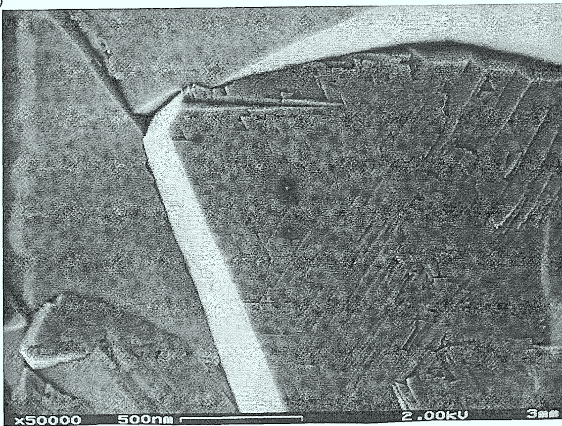
Abb. 4.10. REM-Aufnahme eines (100)-facettierten a) und eines (111)-facettierten b) Diamantkristallits ohne Beaufschlagung durch atomaren Wasserstoff (Aufnahmen: Dr. Jaksch, Carl Zeiß AG, Oberkochen /Jak94/).
